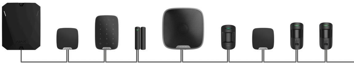
La connexion **en Anneau** occupe deux sorties bus de la centrale. Si l'anneau se rompt à un endroit, aucun dispositif ne sera désactivé. L'anneau se reconfigure en deux lignes, qui continuent à fonctionner normalement. Les utilisateurs et le centre de télésurveillance recevront une notification concernant la rupture de la ligne.
